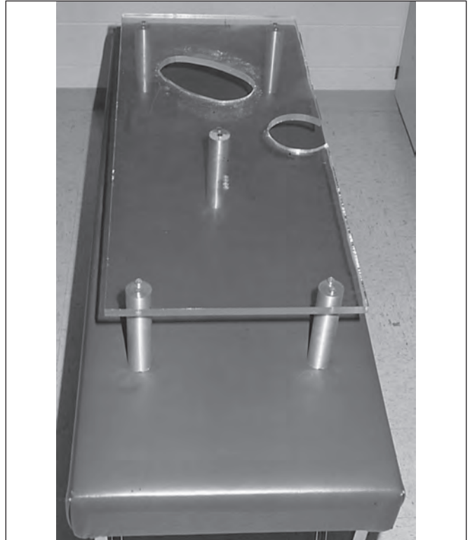
Figura 2.3. Una mesa de escáner con un corte, para permitir obtener imágenes desde debajo del paciente, mejora la calidad de la imagen.
