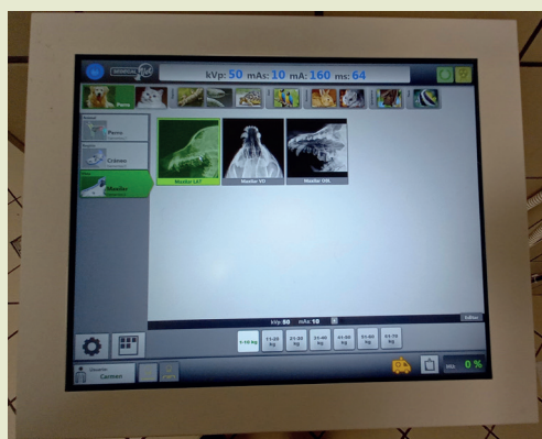
FIGURA 1.8. Consola de control digital, en la que se seleccionan los parámetros de exposición mediante un programa informático, empleando un monitor táctil.
