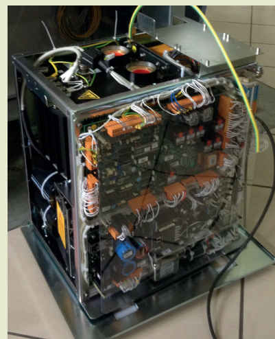
FIGURA 1.7. Imagen del generador de un equipo de rayos X en el proceso de instalación. ►
